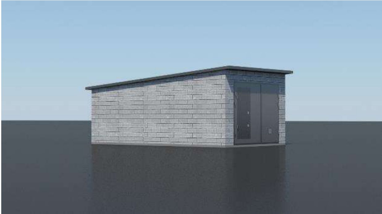
Вариант N 4 Материал стен: металлические листы (для гаражей, расположенных на промышленных территориях)
